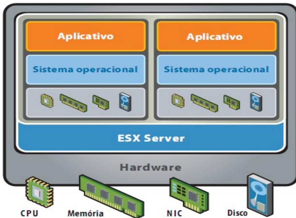
Figura 1: O software ESX Server da fabricante VMWare, virtualiza o armazenamento e a conexão em rede dos servidores, permitindo a execução de vários aplicativos em máquinas virtuais no mesmo servidor físico.
